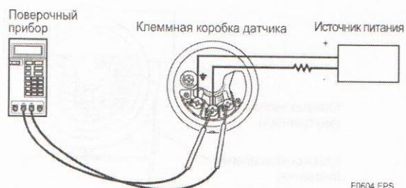
Рисунок 6.4 Подсоединение поверочного прибора
