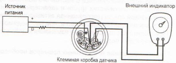
Рисунок 6.2 Подсоединение внешнего индикатора
