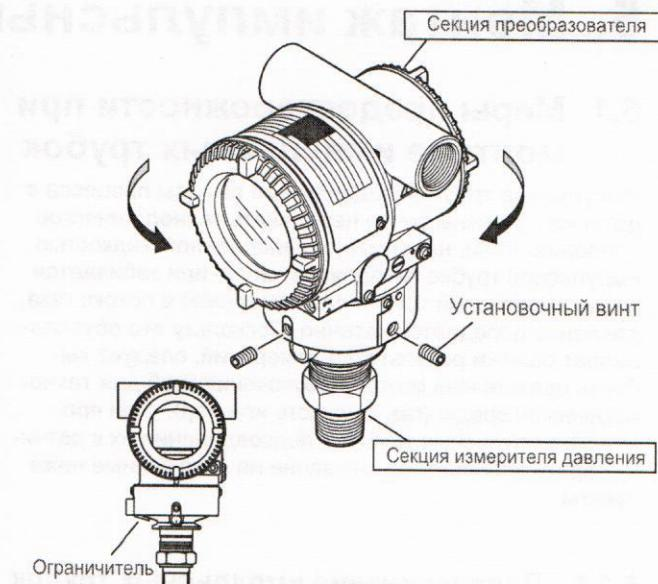
Рисунок 4.4 Вращение секции преобразователя
