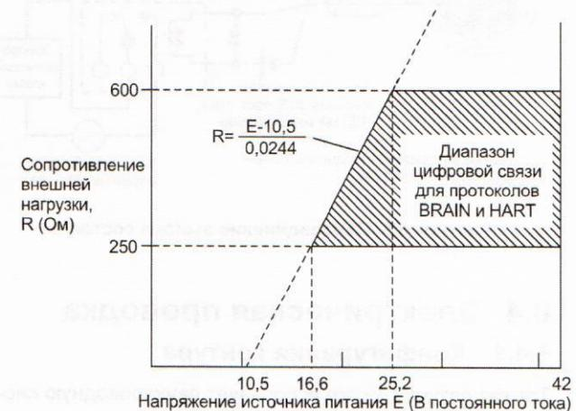
Рисунок 6.12 Зависимость между напряжением питания и сопротивлением внешней нагрузки
