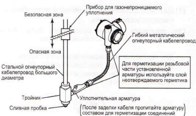
Рисунок 6.10 Прокладка кабеля с использованием металлического огнеупорного кабелепровода
